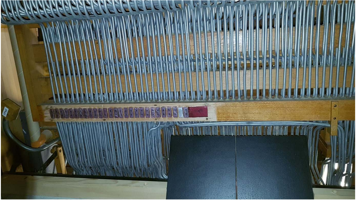
Spieltisch, von vorne gesehen mit geöffnetem Relais der Pedalkoppel I – P. Erkennbar die mit neuem Linoleum belegten Tritte.
