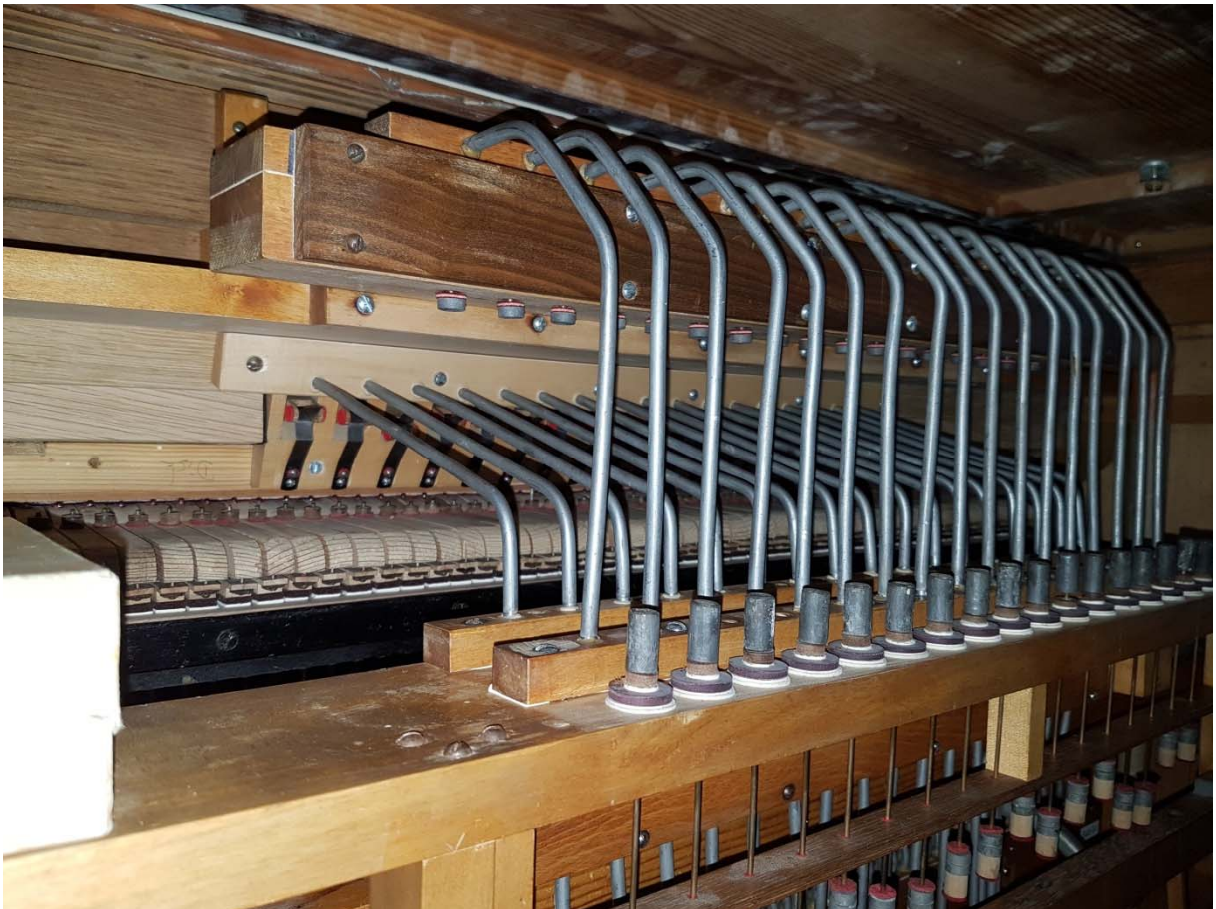
Pneumatische Steuerung der Registertraktur, oben die Anzeigefunktion der Crescendo-Walze.
