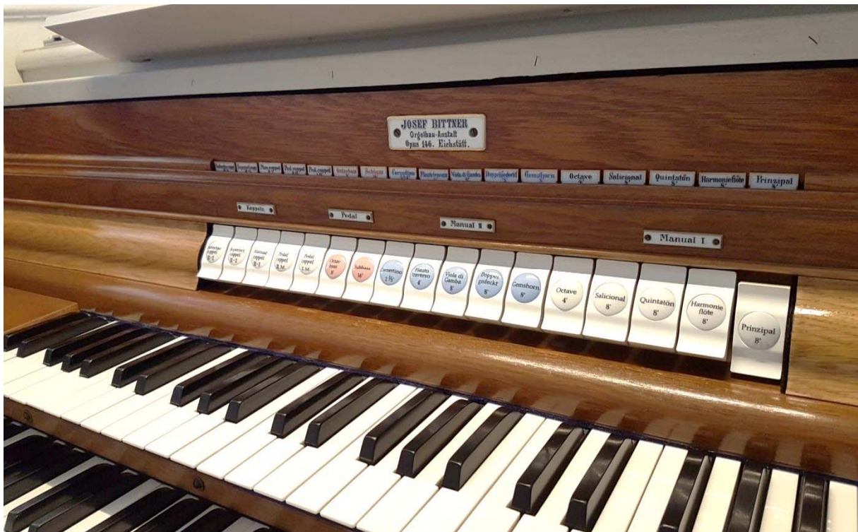
Die rekonstruierten Registerwippen und die eingeschalteten Register des Crescendo; die Beläge der Klaviaturen wurden aus Bein erneuert.
