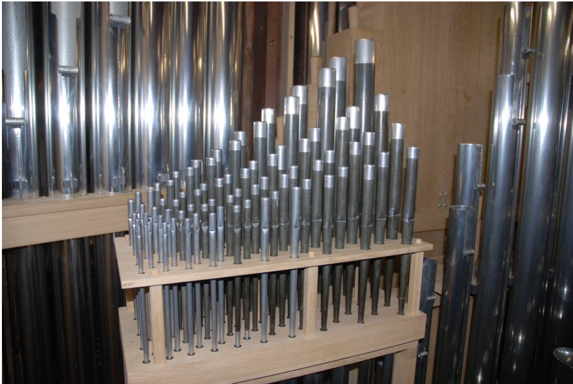
Der hochgebänkte Cornet 4fach, originale und ergänzte Pfeifen
